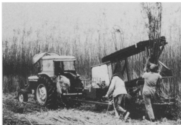
Figure 1. A cropping machine in the Netherlands is harvesting willow-rods grown in short rotation (Photo: Rijksdienst voor de IJsselmeerpolders, Lelystad).
